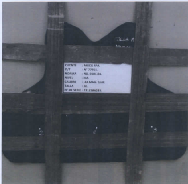
Vista frontal panel anterior Antes del ensayo con cal. .44 MAG. SJHP.
