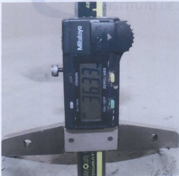
Profundidad señal de impacto Tiro N°2 con cal. .44 MAG. SJHP.
