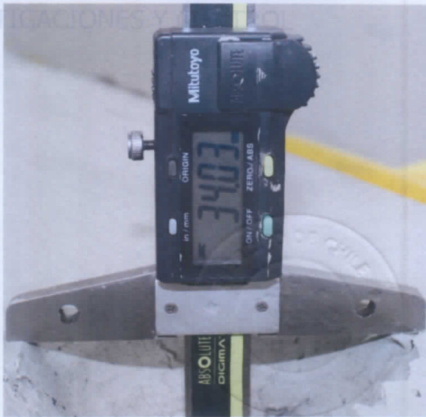
Profundidad señal de impacto Tiro N°3 con cal. .44 MAG. SJHP.
