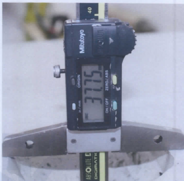
Profundidad señal de impacto Tiro N°1 con cal. .44 MAG. SJHP.
