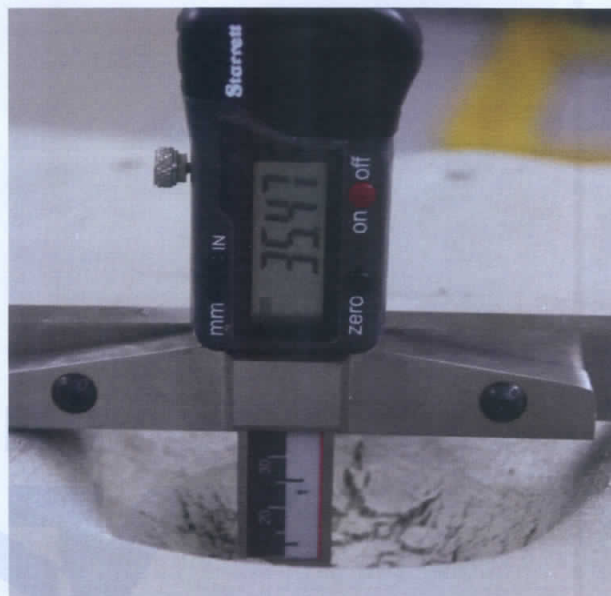
Profundidad señal de impacto Tiro N°1 con cal. 7,62 x 51 mm AP FMJ.
