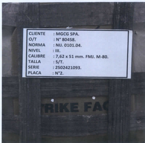
Vista frontal placa balística Antes del ensayo con cal. 7,62 x 51 mm M80 FMJ.
