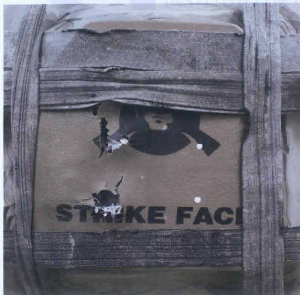
Vista frontal placa balística Tiro N°3 con cal. 7,62 x 51 mm M80 FMJ.
