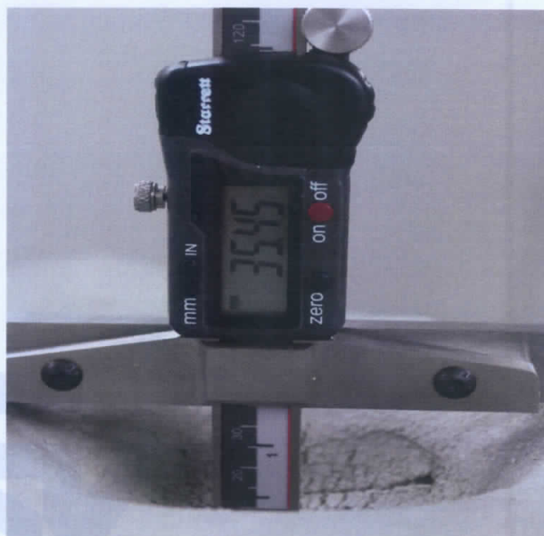
Profundidad señal de impacto Tiro N°1 con cal. 7,62 x 51 mm M80 FMJ.
