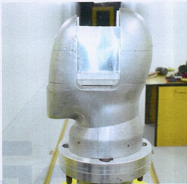
Sin penetración. Placa testigo.
