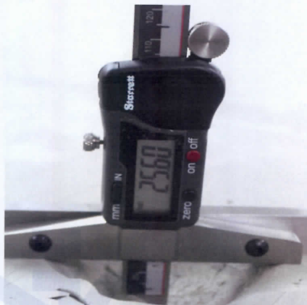
Profundidad señal de impacto Tiro N°1 con cal. 9 x 19 mm FMJ.
