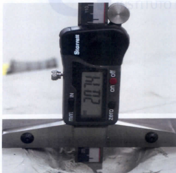
Profundidad señal de impacto Tiro N°2 con cal. 9 x 19 mm FMJ.
