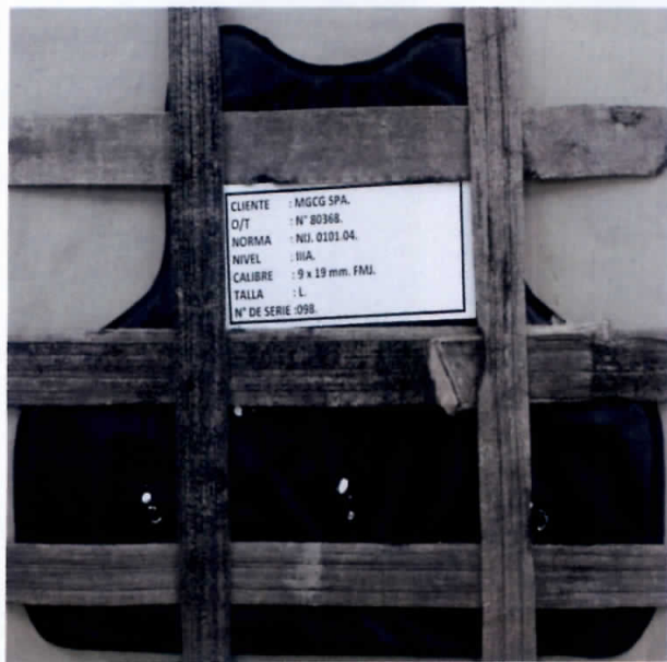
Vista frontal panel posterior Antes del ensayo con cal. 9 x 19 mm FMJ.
